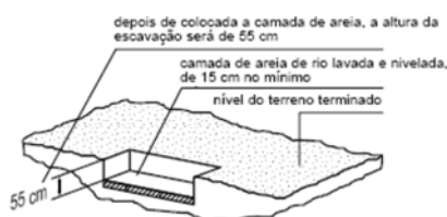
Figura 1 vista do corte do fosso
